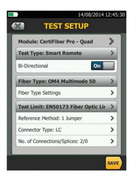
Vous aurez alors à changer certains autres paramètres. Assurez-vous que le type de test est UNITÉ DISTANTE INTELLIGENTE et que bidirectionnel est réglé sur ON. Le type de fibre est correct.
